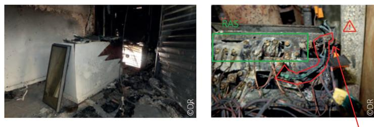
Alimentation du cordon chauffant directement connecté sur l'alimentation principale de l'unité extérieure. Le fil électrique ayant provoqué l'incendie est identifié par sa corrosion de couleur verte caractéristique.
